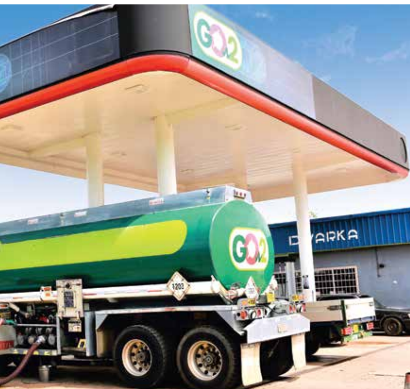
Op een tankstation wordt de brandstof in de ondergrondse olietank verpompt. At a gas station the fuel is pumped into the underground storage tank.
