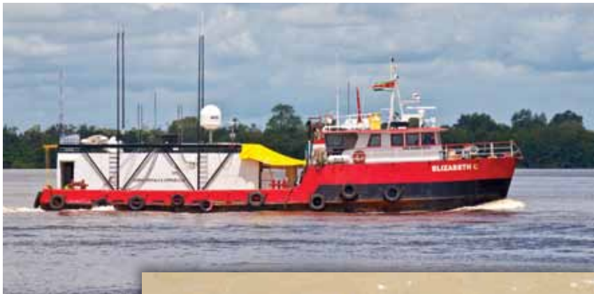
De boot Elizabeth C registreert de gereflecteerde golven die door speciale meetinstrumenten worden ontvangen. De meetinstrumenten bevinden zich in de kabels.
