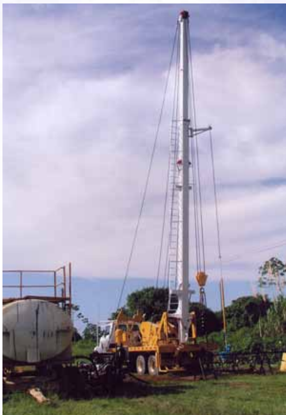
Pulling Unit, bedacht en gemaakt door John L' Espoir. Service Rig designed and built bij John L' Espoir.
