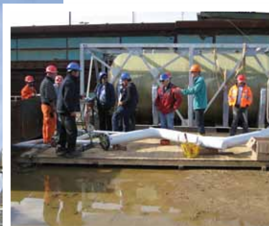
Uitvoeren van hydrotesten op de eerste buizen.
