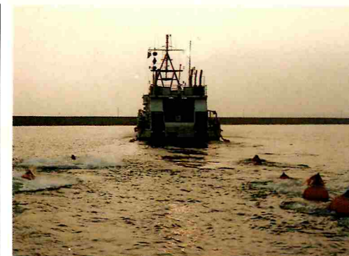
Foto en illustratie hierboven: Speciale schepen worden gebruikt voor seismisch onderzoek op water. Achter het schip hangen de hoge-drukslangen, waaraan de airguns bevestigd zijn. Een lange kabel van ruim drie kilometer bevat de hydrophones.
