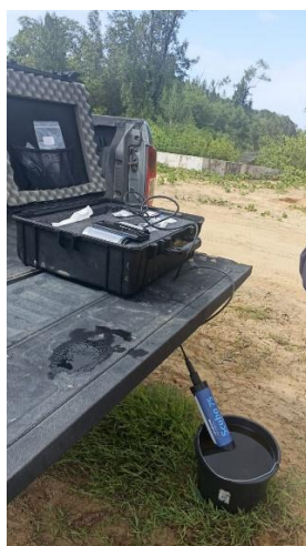
Locatie WNZ-WQ-8: In-situ meting werd in een 10 liter emmer uitgevoerd met een waterkwaliteitsmeter Scuba-75A multiprobe.
