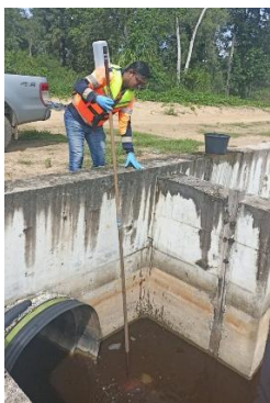
Locatie WNZ-WQ-8: De transparantie van het water werd bepaald met een Secchi-schijf.
