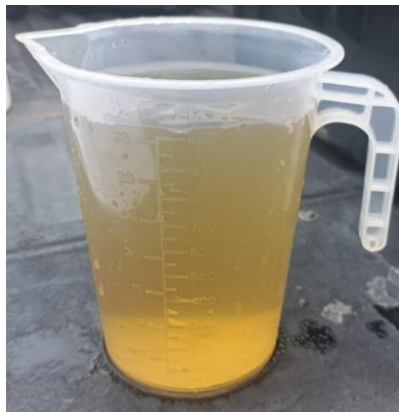
Locatie WNZ-WQ-3: Er werd een lichtbruine kleur van het water waargenomen, met zowel drijvende als neergeslagen deeltjes. De helderheid van het water was licht troebel. Geen vervuiling waargenomen. Geen geur waargenomen.
