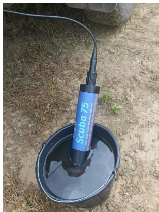
Locatie WNZ-WQ-3: In-situ meting werd in een 10 liter emmer uitgevoerd met een waterkwaliteitsmeter Scuba-75A multiprobe.
